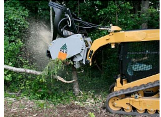
Модель представляет собой обновленную версию одного из самых востребованных продуктов гаммы FAE. Дизайн и качество были полностью пересмотрены: прочная и компактная модель мульчера UML/SSL выделяется эргономичным дизайном, который гарантирует оператору отличную видимость в процессе выполнения различных работ.
