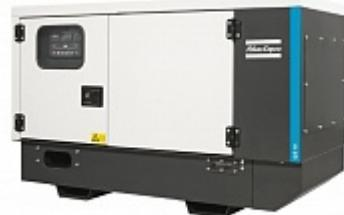
Дизельный генератор QIS 10 (230V) мощностью 7,2/8,2 кВт при основной нагрузке, имеет ёмкость топливного бака 55 литров и его топливная автономность при сто процентной нагрузке составляет 22 часа. Двигатель Kubota D1105-BG-50HZ, объёмом 1,12 литров обеспечивает экономичную и, относительно, мало шумную работу генератора.
